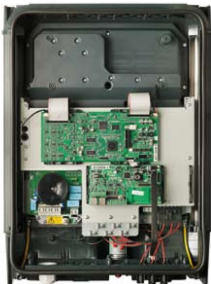
▲ Der TLX 15 k ist ein sehr modernes, klar und fertigungsfreundlich aufgebautes Gerät, das wegen seiner mehrlagigen Innenarchitektur aber nicht alle Bereiche für
